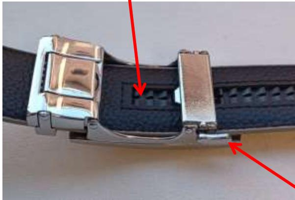
Der Schließmechanismus wird durch den seitlichen **Knopf** aktiviert. In der Schließe befindet sich eine Feder mit einem Magneten. Sie rastet beim Durchziehen des Gürtels durch die Automatikschließe in die Vertiefungen ein und lässt sich mit dem kleinen Knopf wieder lösen.
